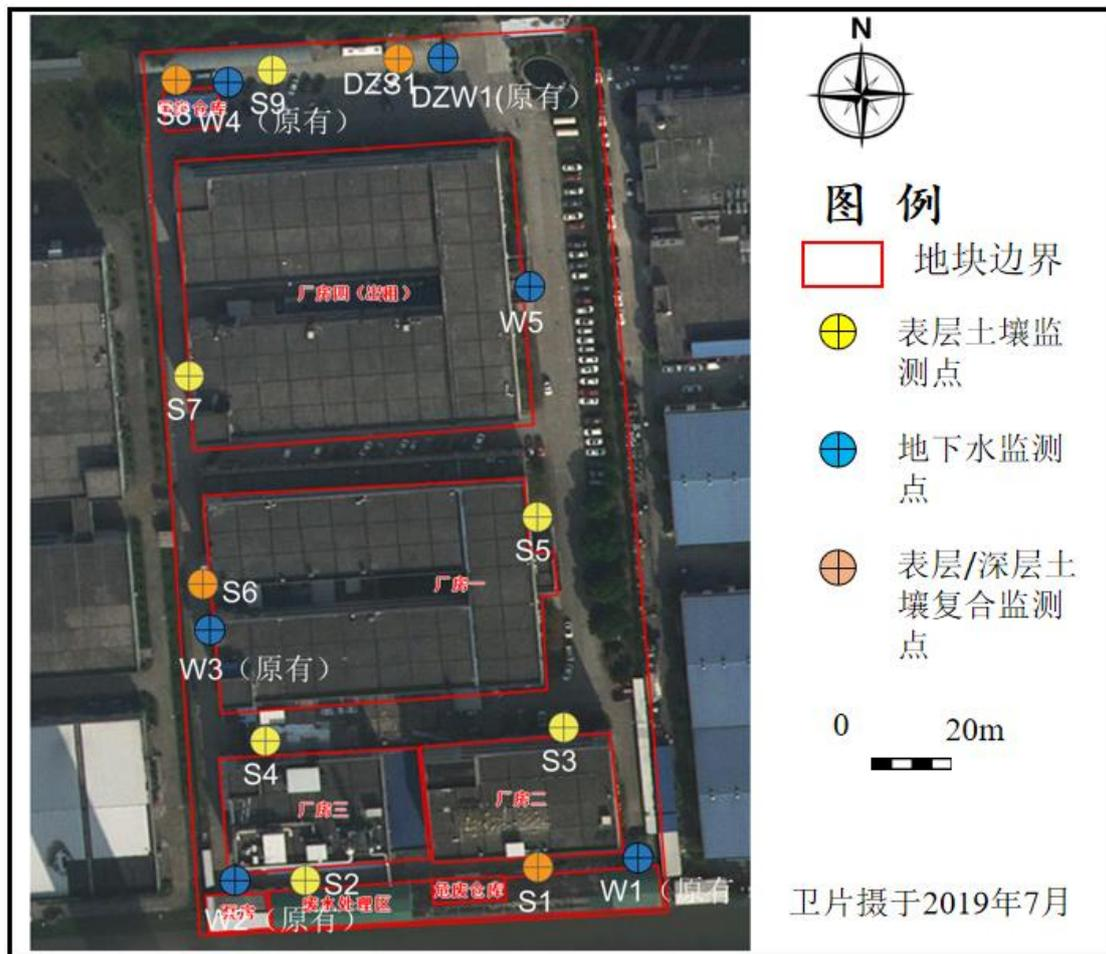
图 6.3-1 土壤和地下水监测点布点图
